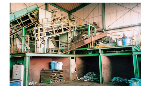
自動選別機 磁力でスチール缶とアルミ缶を分けています
