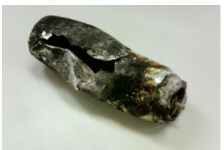
収集車の中で破裂して燃えたスプレー缶
