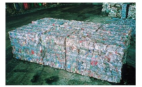
プレス品 運びやすいように固めます
