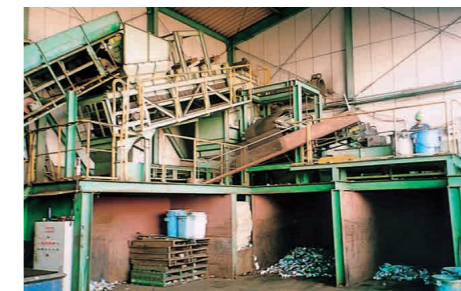
Máy phân loại tự động Lon thép và lon nhôm được phân loại bằng nam châm
