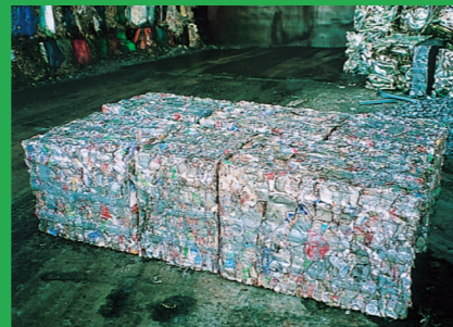
Bloques prensados. Se prensan de modo que se facilite el transporte.
