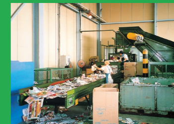
Máquina cortando las cuerdas y separación a mano de los objetos extraños
