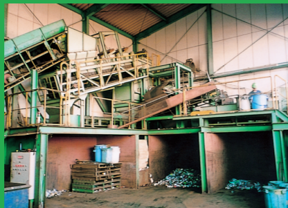
Máquina de separación automática. Las latas de acero y de aluminio se separan mediante fuerza magnética.
