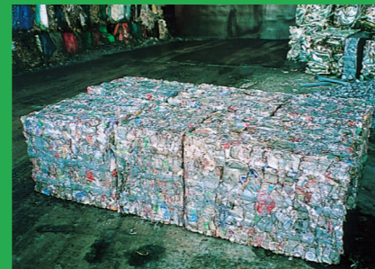
Latas prensadas Compactadas para facilitar a transportação.
