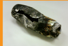
Lata de aerossol que explodiu e queimou no carro coletor de lixo
