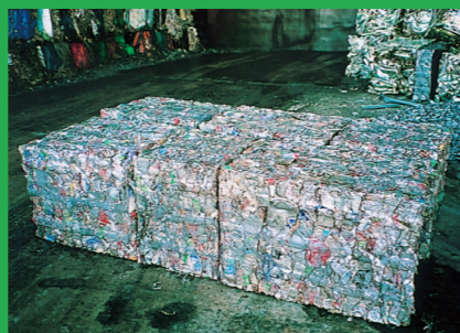
挤压品 挤压成便于搬运的块状
