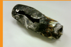
在垃圾回收车中破损燃烧的喷雾罐
