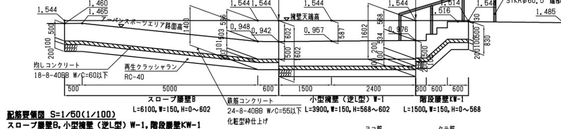
断面図 S=1/50(1/100) 擁壁(共通)
