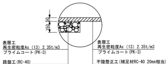
※舗装打継部に舗装成形目地 (W-40) を接着施工すること。
