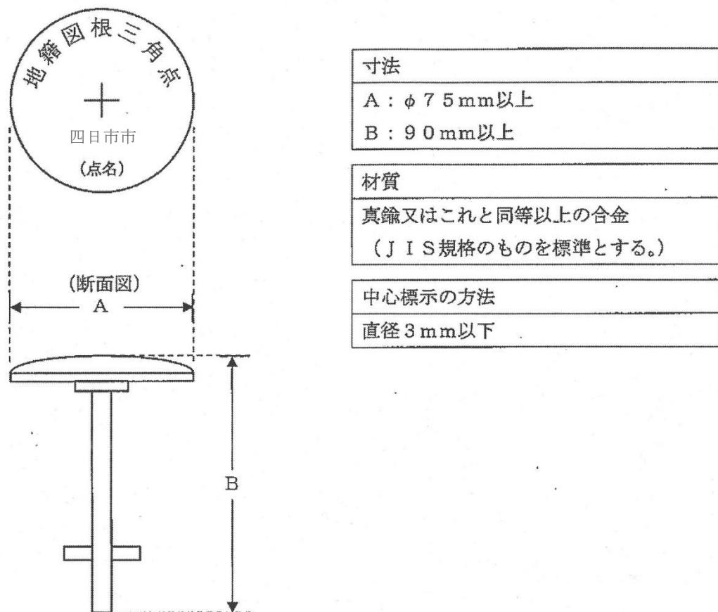
(2) 地籍図根三角点の保護工の構造
