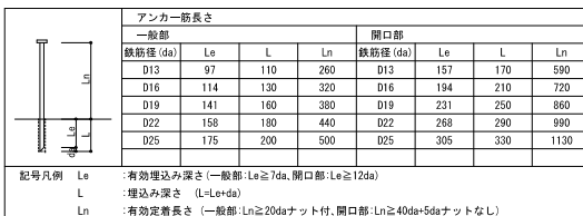
接着系アンカー配筋標準
