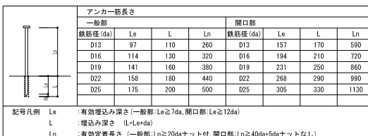
接着系アンカー配筋標準
