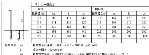
接着系アンカー配筋標準
