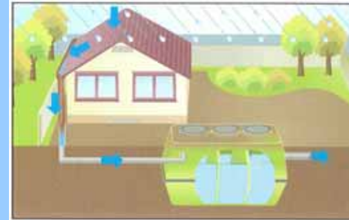
不要浄化槽の貯留槽化
