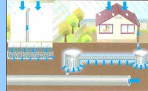
透水性舗装・浸透施設の設置
