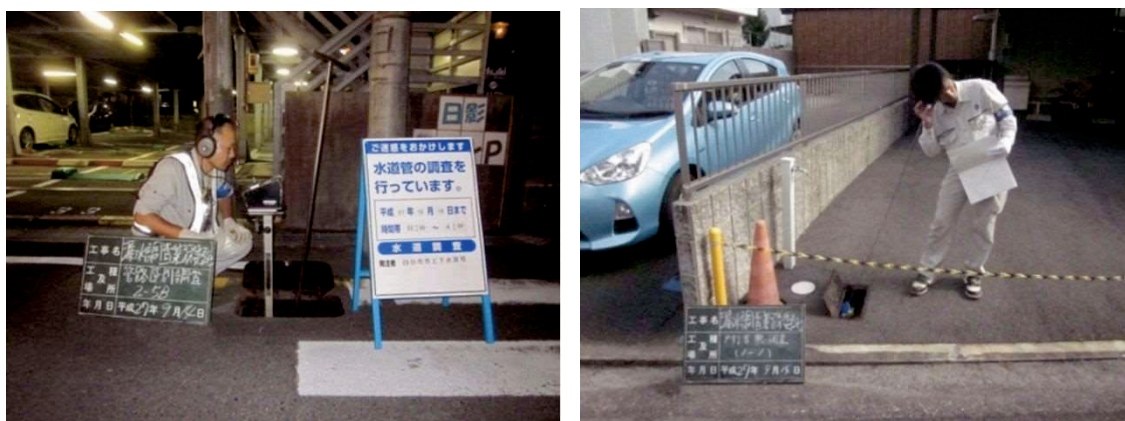
漏水調査の様子
