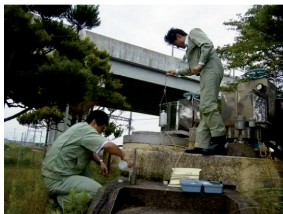
取水井（井戸）での採水状況
