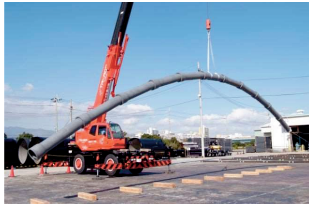
耐震管（ダクタイトル鉄管 GX 形） （出展：（一社）日本ダクタイトル鉄管協会）
