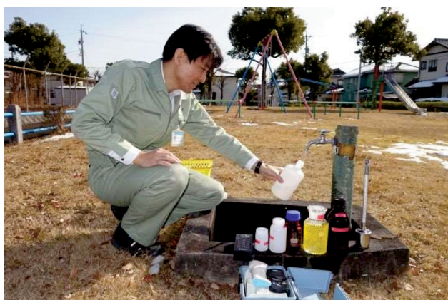
給水栓での採水状況
