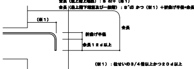
3. 5. 2図 梁主筋の柱内定着要領
