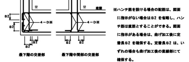
3.15.4 図 壁と床の交差部及び端部の配筋
