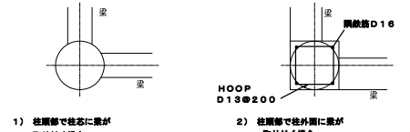
4. 19. 3 図 円柱の取り合い配筋
