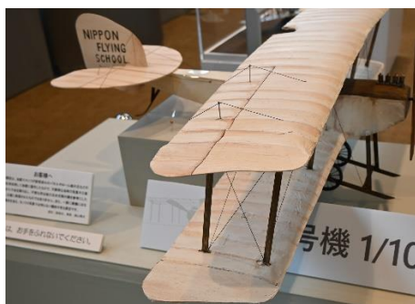
羽布を再現した 1/10 模型の主翼
