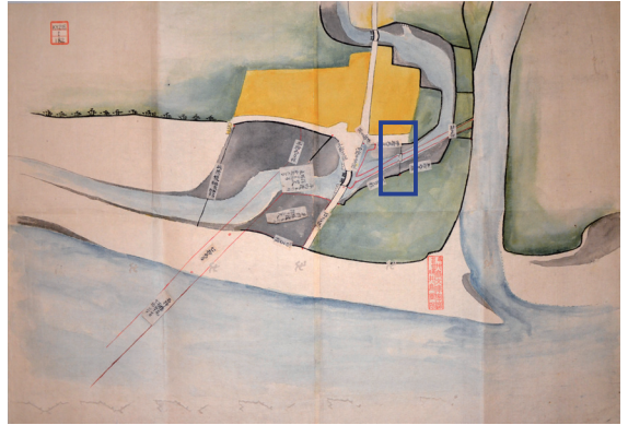
図5 四日市町の庄屋、井島家に残された江戸時代後期の湊改修計画図(館蔵)。湊橋(中央)の右にある橋が延絵図の板橋と一致する。黄色は納屋町の範囲、緑は新田、灰色は浅くなった湊部分。湊機能を回復させるために川の浚渫をし、湊口の付け替え(左下)と三滝川からの取水(右上)を計画し、付け替え工事は完成した。枠囲いにある橋(図5-2)は延絵図の板橋にあたる。
