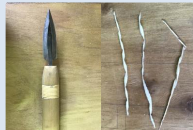
ヤリガンナ(左)とヤリガンナの削りくず(右)
